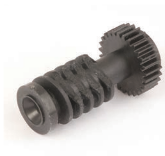
Отказ червячной передачи из-за ограничения VNT механизма.
