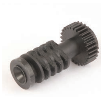
Usterka przekładni ślimakowej na skutek ograniczenia mechanizmu VNT.
