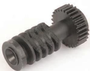
Guasto all'ingranaggio a vite senza fine a causa del funzionamento limitato del meccanismo VNT.
