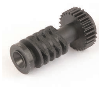
Défaillance des vis sans fin à cause d'un mécanisme VNT restreint.
