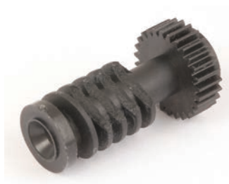
Fallo de engranaje helicoidal debido a restricción en el mecanismo de geometría variable.
